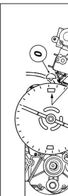
**88713.0123** e il comparatore **88765.1297** nel foro della candela del cilindro orizzontale.
